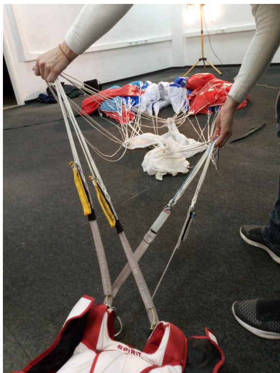
Рисунок 24 -Задние СК - в левую руку, передние СК - в правую руку
