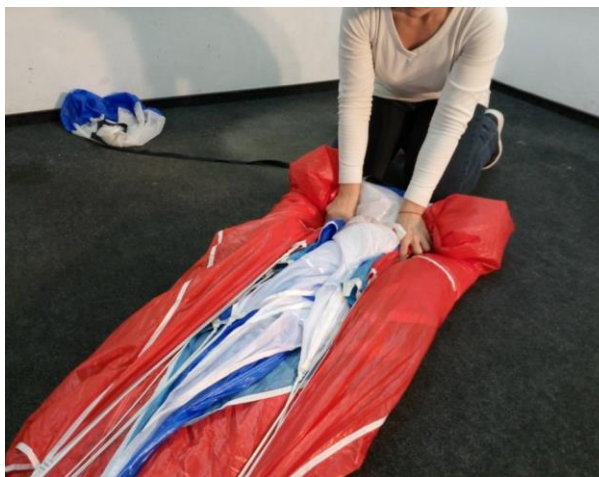
Рисунок 46 - Сворачивание левой и правой сторон задней кромки навстречу друг другу (одновременно и симметрично)
