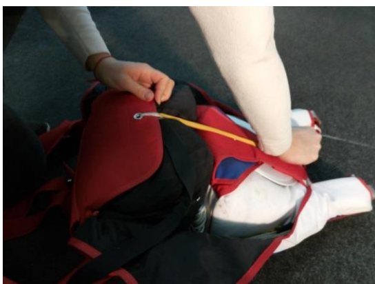
Рисунок 82 - Затяжка нижнего клапана
