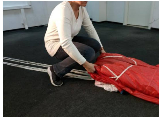
Рисунок 63 - Выполнение S-образного сложения
