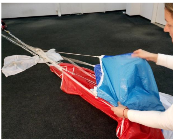
Рисунок 38 - Укладка задней кромки купола, левая сторона
