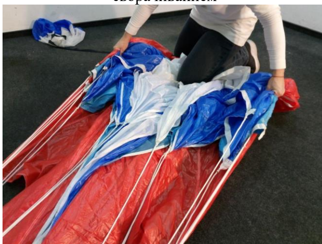
Рисунок 45 - Сворачивание левой и правой сторон задней кромки навстречу друг другу (одновременно и симметрично)
