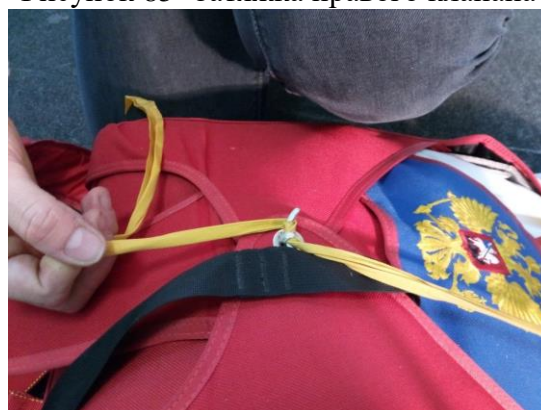
Рисунок 87 - Извлечение ленты - затяжки
