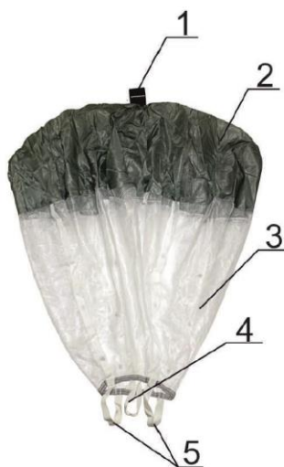
Рисунок 11 - Парашют вытяжной мягкий
