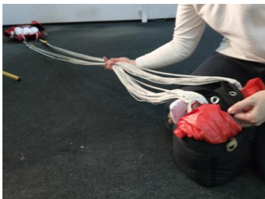
Рисунок 70 - «Сгон» слабины строп в сторону фартука камеры
