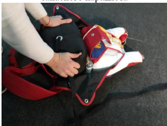
Рисунок 80 - Укладка камеры с уложенным ОП «Фокус» в отсек ОП
