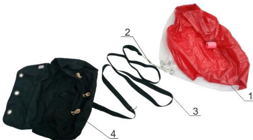
Рисунок 19 - Соединение МВП со звеном вытяжным ОП, камерой ОП и звеном с вертлюгом
