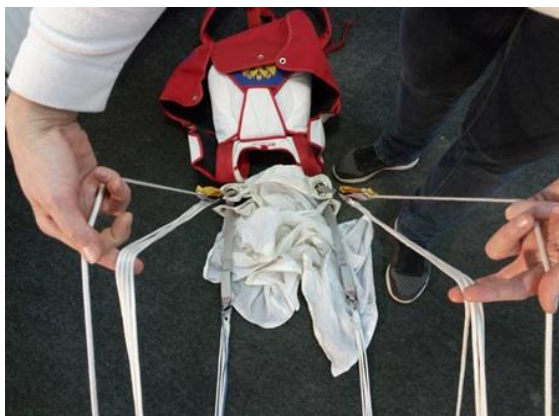
Рисунок 20 - Разделение строп для проверки
