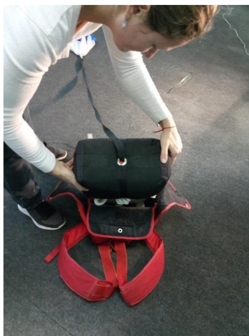
Рисунок 77 - Установка камеры вертикально в отсек ОП
