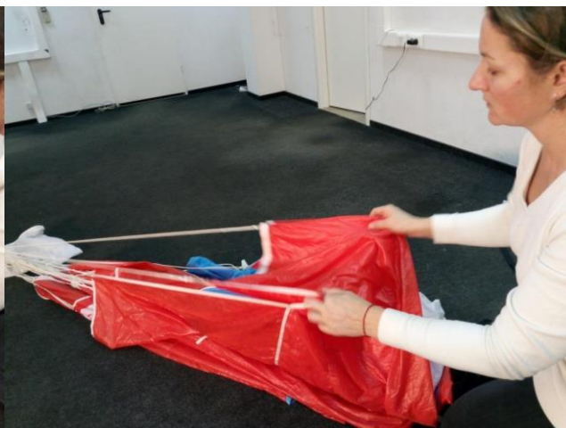
Рисунок 37 - Укладка задней кромки купола «хвоста», левая сторона
