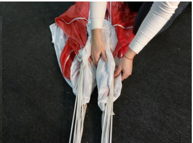
Рисунок 53 - Расправление слайдера между левыми и правыми группами строп – «пробивка» посередине
