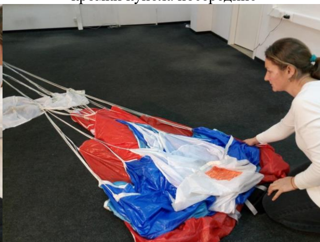
Рисунок 43 - Налистанные левая и правая стороны задней кромки купола перед сворачиванием
