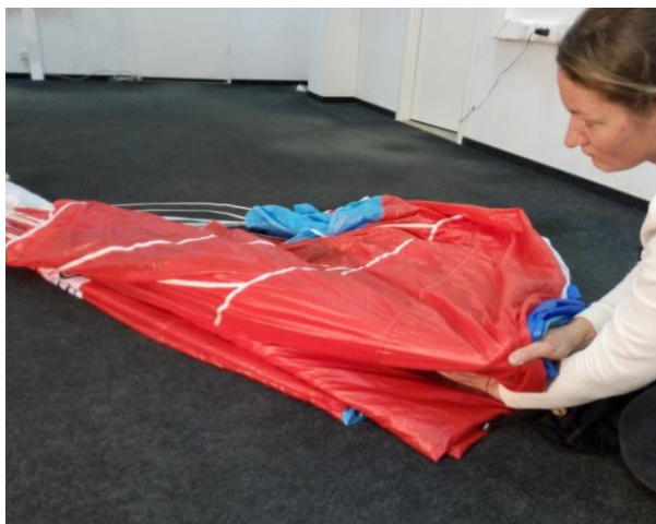
Рисунок 36 - Выполнение «S»-образного сложения
