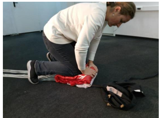
Рисунок 65 - Сворачивание ОП для укладки в камеру
