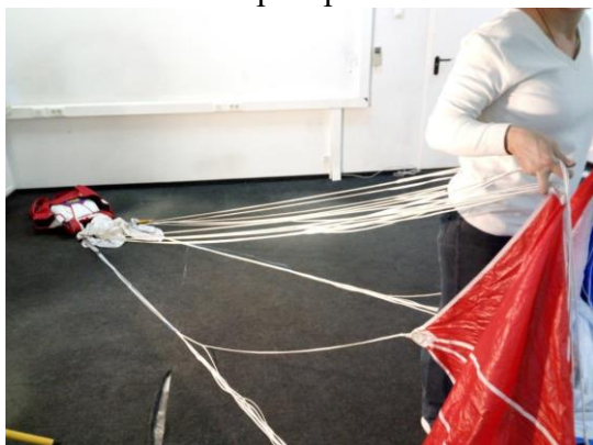
Рисунок 22 - Проверка на деление «верх-низ»
