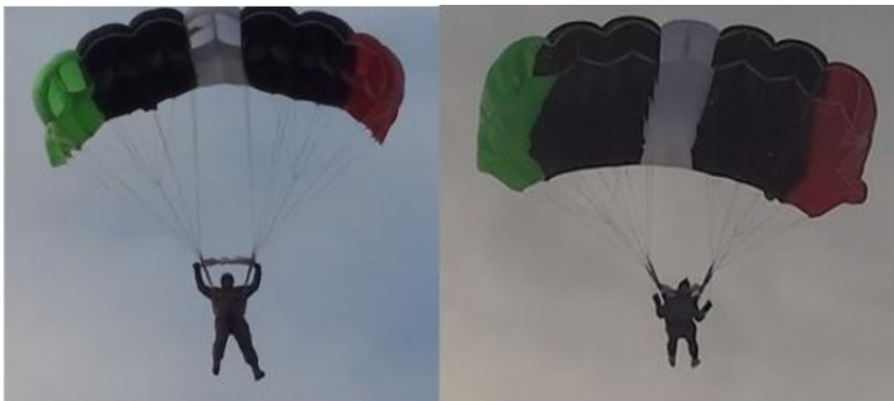
Рисунок 15 - Влияние расположения слайдера на «развал» ОП
