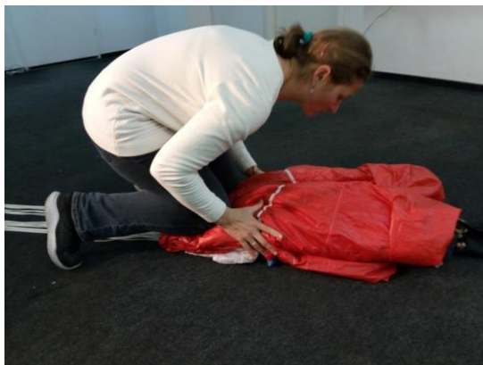
Рисунок 64 - Сворачивание ОП для укладки в камеру
