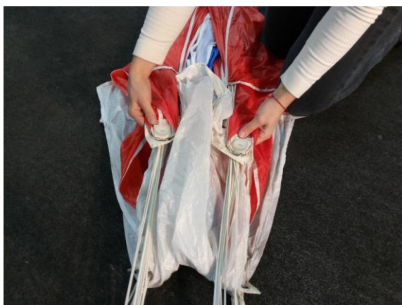
Рисунок 56 - Контроль расположения ограничителей («таблеток»)
