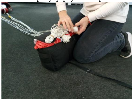
Рисунок 72 - Укладка третьего пучка строп на фартуке
