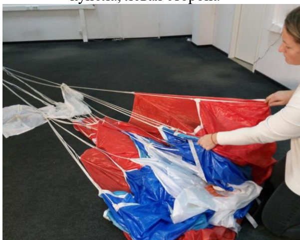
Рисунок 42 - Укладка задней кромки купола, правая сторона
