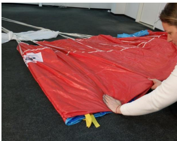
Рисунок 34 - Выполнение «S» - образного сложения
