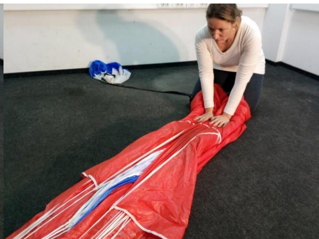
Рисунок 47 - Сворачивание левой и правой сторон задней кромки навстречу друг другу (одновременно и симметрично)
