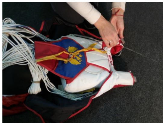
Рисунок 79 - Зачековка предохранительных клапанов
