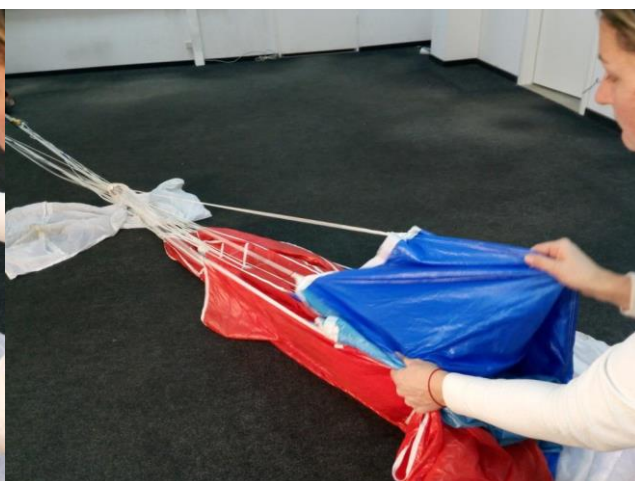
Рисунок 39 - Укладка задней кромки купола, левая сторона
