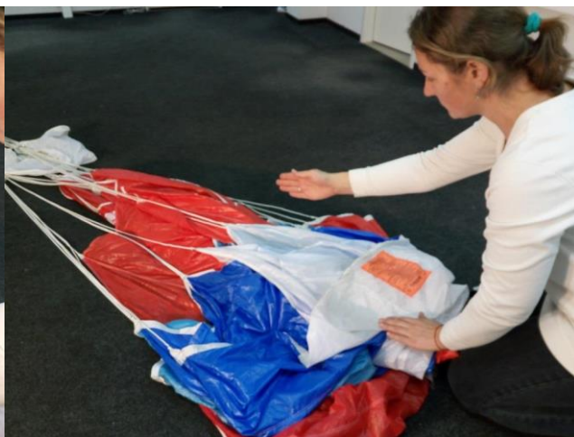
Рисунок 41 - Ориентирование центра задней кромки купола посередине
