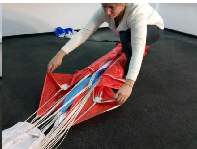
Рисунок 49 - Расправление «ушей» между 2-ым и 3-им рядом
