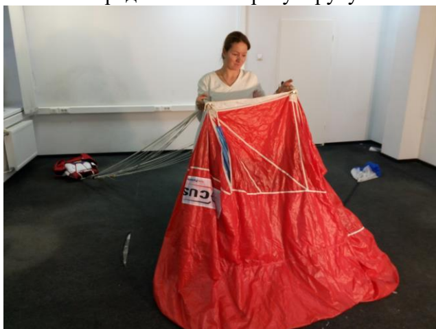
Рисунок 26 - Разложение купола в профиль», вид спереди
