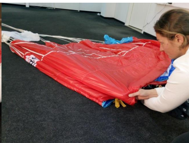
Рисунок 35 - Выполнение «S» - образного сложения
