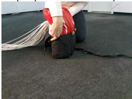
Рисунок 68 - Укладка в камеру
