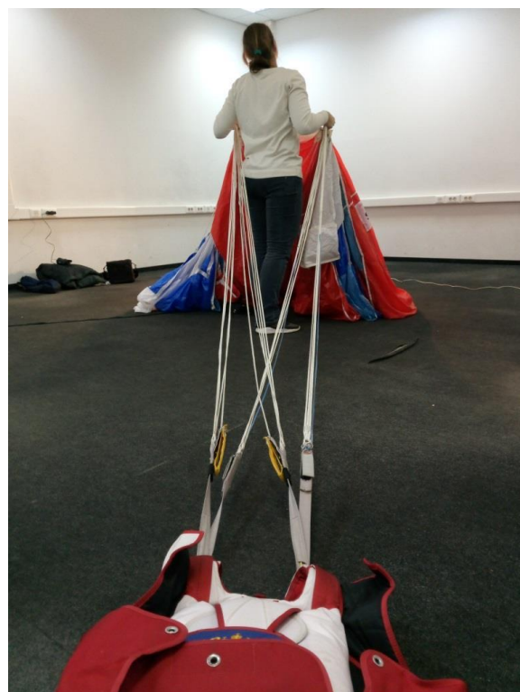
Рисунок 25 - Разложение купола в «профиль», вид сзади
