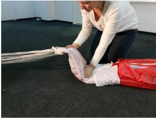
Рисунок 60 - Выполнение S-образного сложения
