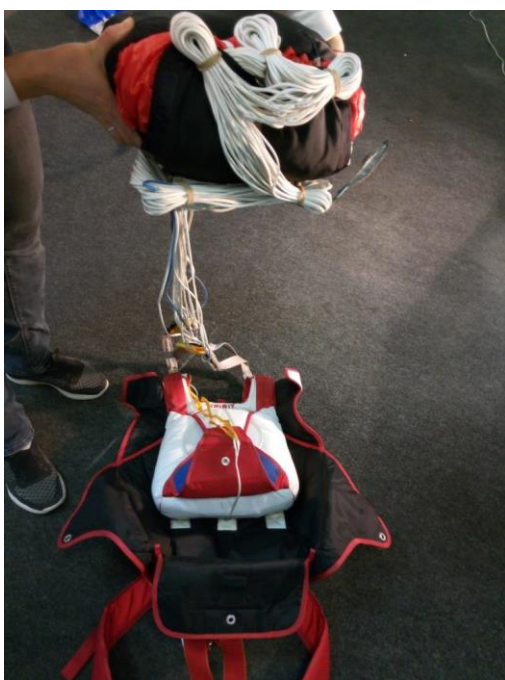
Рисунок 76 - Перенос камеры в отсек ОП
