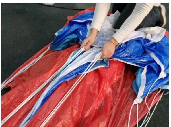
Рисунок 44 - Ориентирование строп 4-го ряда посередине (6 шт.)
