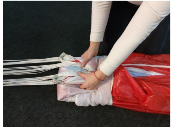
Рисунок 61 - Выполнение S-образного сложения
