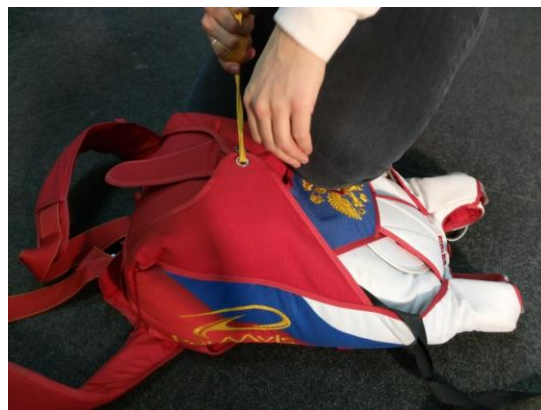
Рисунок 85 - Затяжка правого клапана
